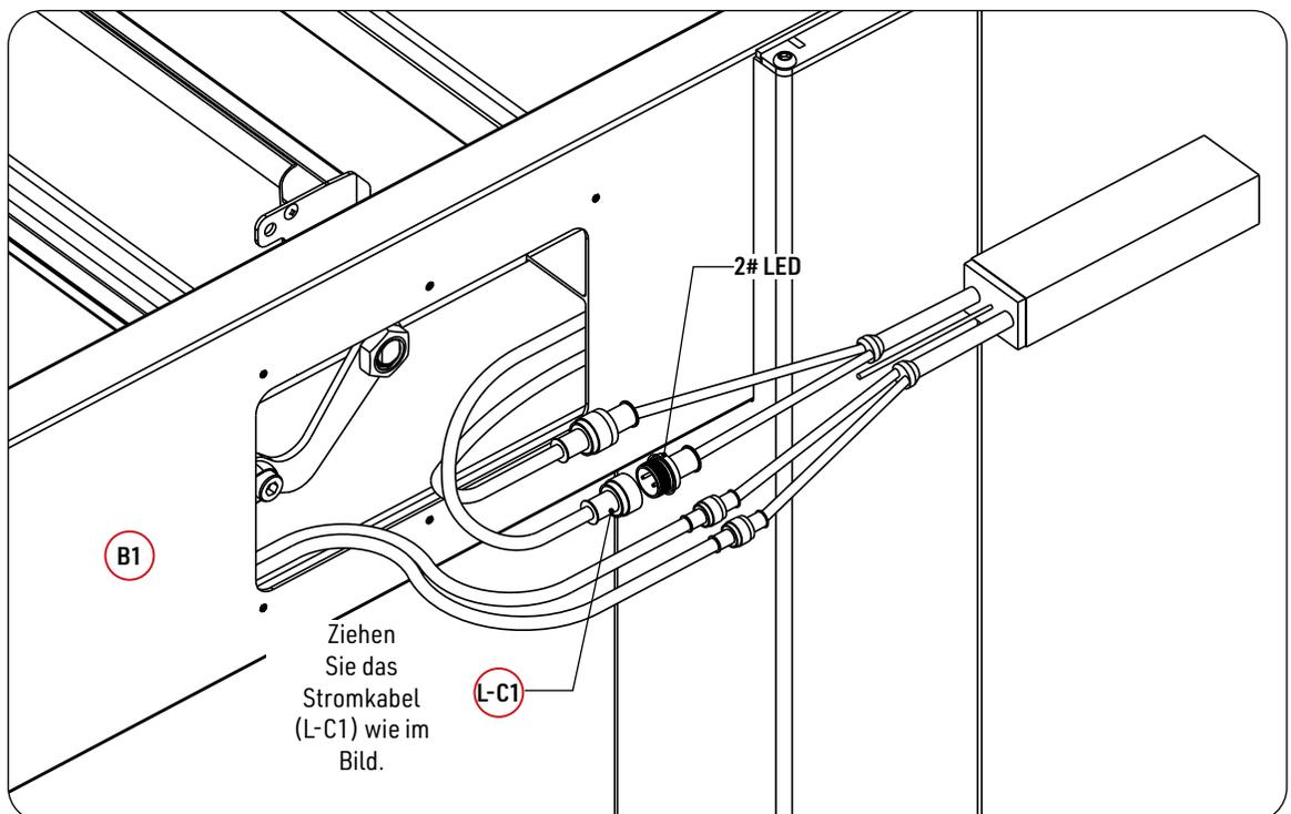
Installieren Sie alle LED-Streifen in einer Reihe und verbinden Sie anschließend die beiden Enden des LED-Streifens mit den beiden Ausgangsleitungen des LED-Controllers (L-C1).
