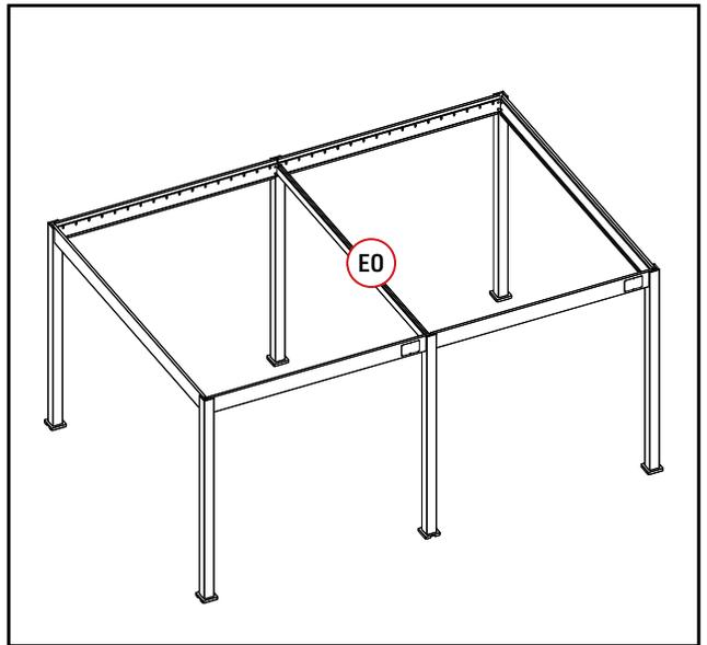
Befestigen Sie die Balken an den Pfosten.
