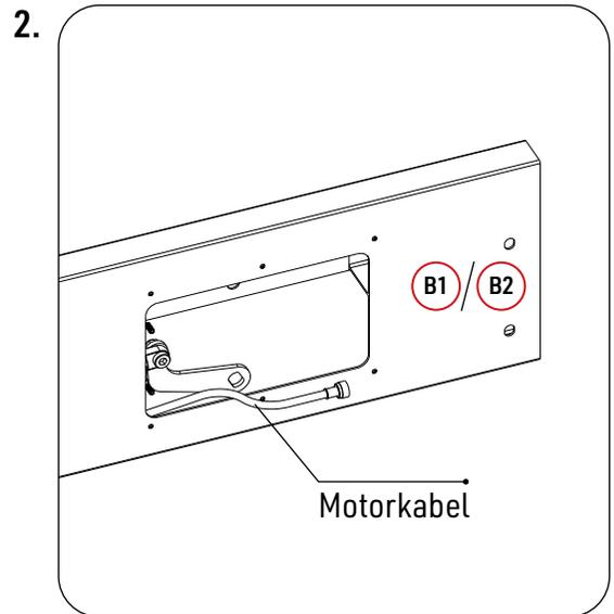
Führen Sie das Kabel E-P1 durch B1.
