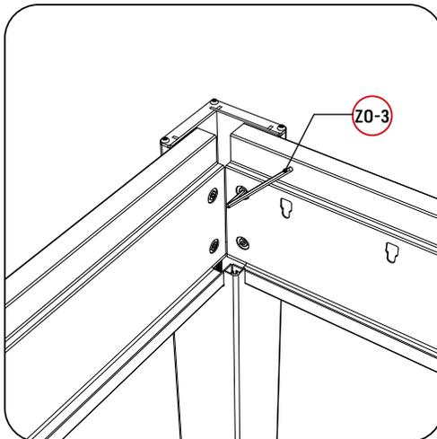
Verwenden Sie den Akkuschauber, um die Schrauben an der Platte zu befestigen, und ziehen Sie die Schrauben anschließend mit dem Schraubenschlüssel fest.
