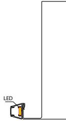
Führen Sie die Ausgangsleitung des LED-Controllers (L-C1) in die Aussparung des Pfostens ein.
