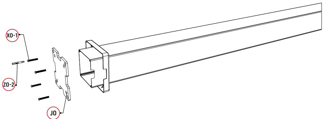
Verwenden Sie den Akkuschauber, um die Schrauben an der Platte zu befestigen, und ziehen Sie die Schrauben anschließend mit dem Schraubenschlüssel fest.
