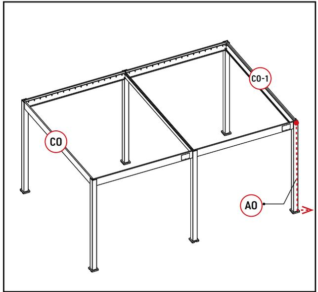
Setzen Sie den Transformator in die Öffnung von CO-1 ein. Bitte achten Sie darauf, genügend Länge des Stromkabels zu lassen.
