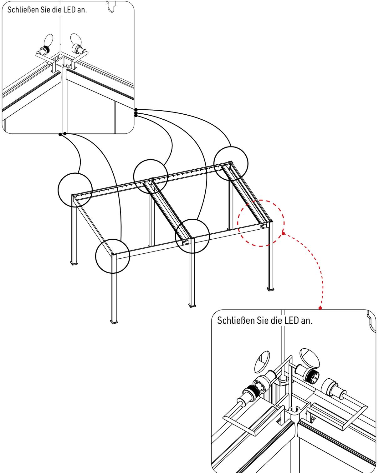
Stecken Sie den Strom ein, wenn die Verbindungen ordnungsgemäß vorbereitet sind, und drücken Sie die Taste „LED SWITCH“, um die LED-Leuchten ein- oder auszuschalten.
