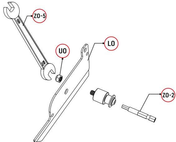
Montieren Sie die Antriebe für die Lamellenabdeckung auf beiden Seiten der Lamellen.
