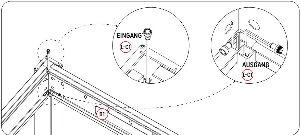
Verbinden Sie die Eingangsleitung des LED-Controllers (L-C1) mit der LED 2# des Controllers
